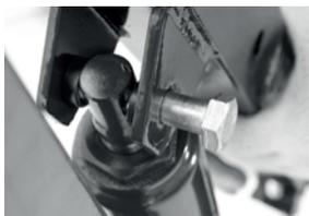
9- A corrente e o gancho devem ser montados através do furo no braço do equipamento, passando o parafuso pelo elo da corrente;
