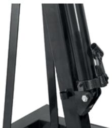
8- O braço deve ser montado na torre, após o aperto de parafusos, porcas e arruelas conecte-o ao sistema hidráulico, utilizando espaçadores;
