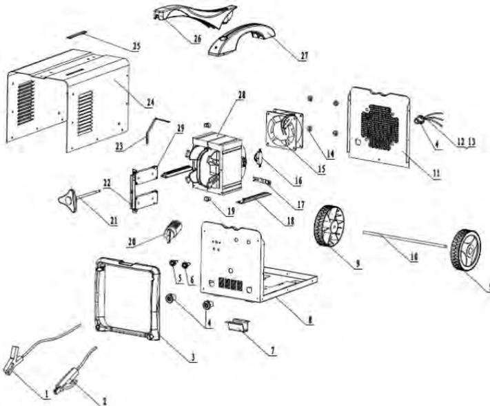
**1. Garra negativa****2. Porta-eletrodo****3. Protetor da capa****4. Prensa cabo****16. Protetor térmico****17. Grampo parafuso do manipul****18. Suporte fixação****19. Grampo**
