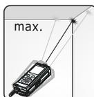
Figura 20 - Função de medição contínua, utilizando o máximo da medição
